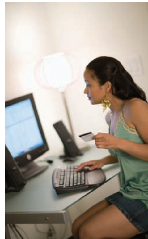
Figure 5.20 Ce clavier est doté d'un support ergonomique pour les poignets. Ce support réduit les microtraumatismes répétés.
