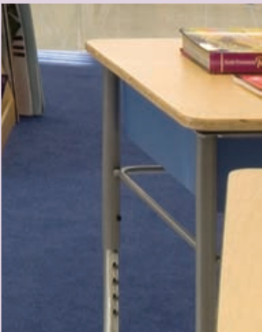
Figure 5.2 Le pied du bureau est soudé à la barre horizontale et sa hauteur peut être ajustée à l'aide d'un boulon.
