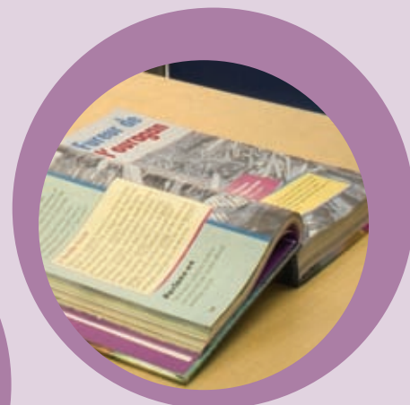
Figure 5.4 Les pages de ce livre sont cousues ensemble avec du fil, puis collées à la reliure.
